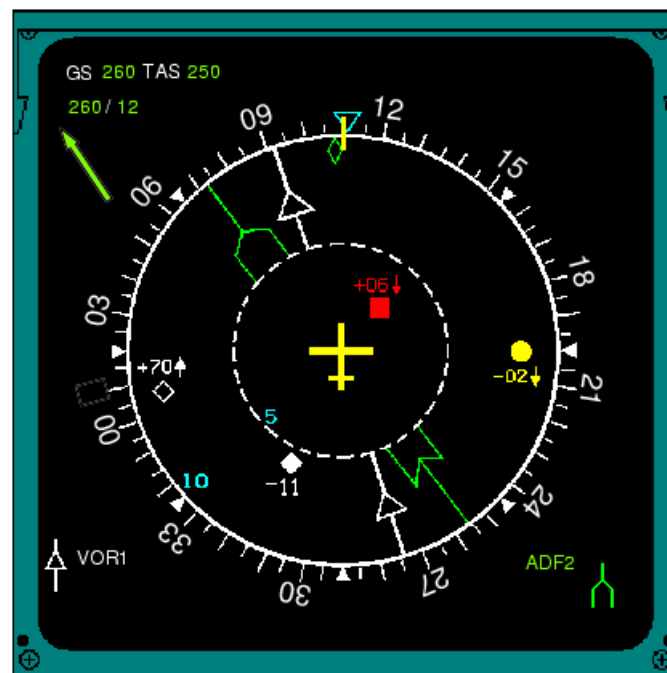
Рис. 5. Система EFIS – Индикатор навигационной обстановки в режиме «РОЗА» с отображением воздушных судов.
